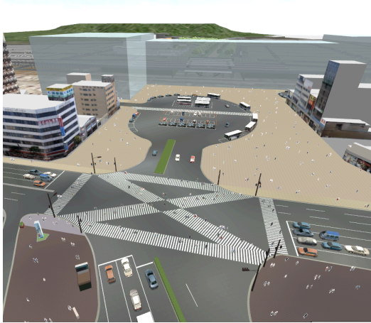
大分駅北エリア、左は大分市の計画 国道10号は平面で横断歩道となるためバリアが大きい 右は経済界のプラン、国道のアンダーパス化により人の横断するバリアは格段に小さくなる
