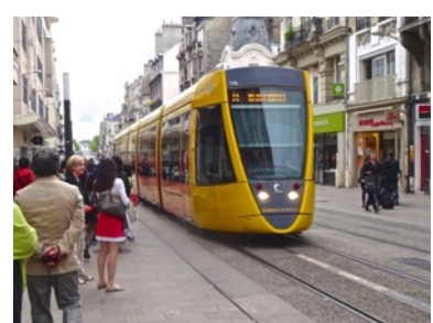
ランスのLRTは2011年開業 郊外はバンタグラフで架線から給電されて走るが、街中や景観的配慮が必要な場所は路面より給電される（視察を行ったボルドーと同様の方式）
