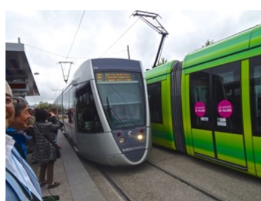
ランスのLRTは2011年開業 郊外はバンタグラフで架線から給電されて走るが、街中や景観的配慮が必要な場所は路面より給電される（視察を行ったボルドーと同様の方式）
