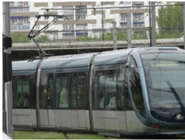
LRT、郊外ではパンタグラフで給電
