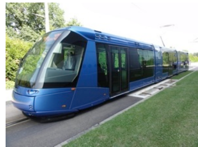
ロール社ゴムタイヤ・タイプの新型 LRT 「トランスロール」
