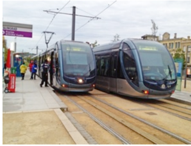
ガロンヌ川のピエール橋を渡った個所で架線レス←パンタグラフ給電方式を切り替える
