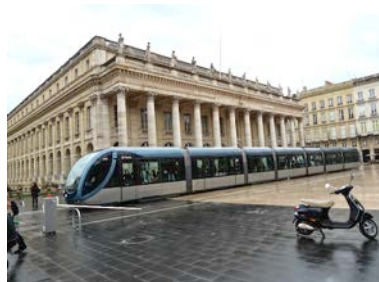
古都の景観保全を図るために架線レスのLRTを導入したボルドー
