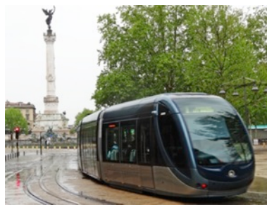
世界遺産都市の旧市街では景観を重視し、LRTは中心部では架線レス、地下給電方式を採用している
