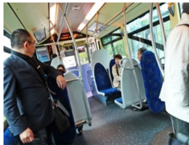
BRTの乗降は低床でバリアフリー、車内は低床でフラット、LRTに比べて運行ノウハウは必要だが整備コストは圧倒的に低いBRTはかなり魅力的に思えた
