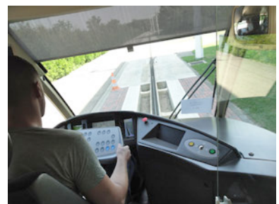
1本軌道ゴムタイヤ式の次世代型LRT
