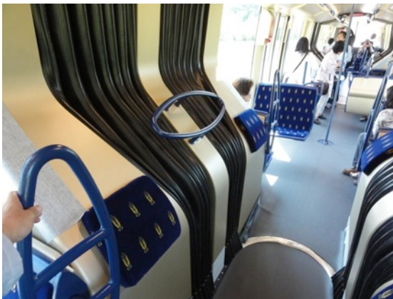
車両連結部にタイヤハウスがあり床は全面フラット化されている。
